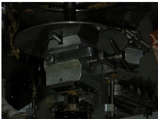
Рисунок 5 а - Процесс литья восковой модели
