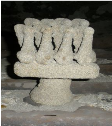
Рисунок 5 в - Сформованная литейная система
