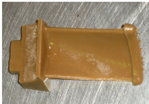
Рисунок 5 б - Отлитая восковая заготовка
